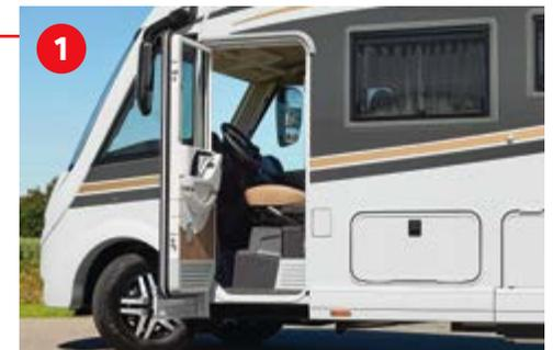
^ Fahrertür mit niedrigem Türeinstieg und Sicherheitsdoppelverriegelung.
