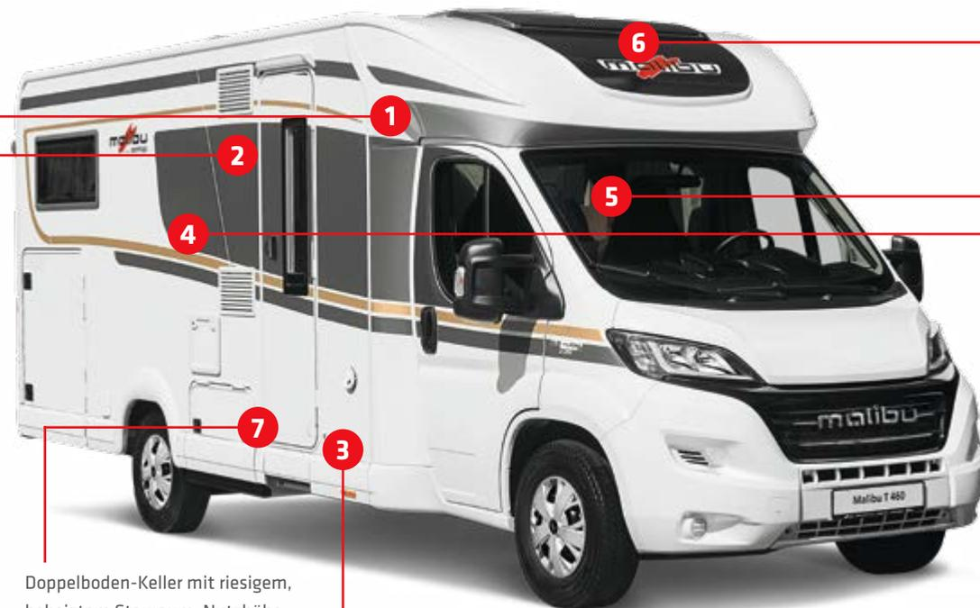
Doppelboden-Keller mit riesigem, beheiztem Stauraum, Nutzhöhe bis zu 48 cm. Zugang über große Außenklappen. Innenzugang über große Wohnraumbodenklappe in den tief abgesenkten Stauraumkeller. Bequem beladbar auch durch die Eingangstür.
