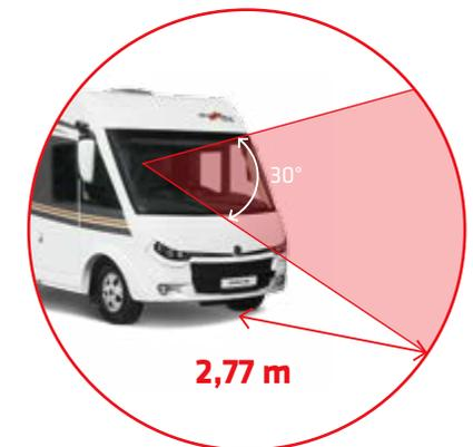
^ Testbestwert für die Sicht auf die Fahrbahnoberfläche nach nur 2,77 m
