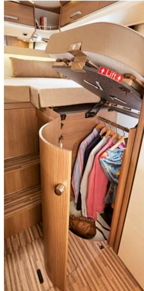
^ Die Kleiderschränke sind bis in den Doppelboden abgesenkt und bequem von oben und von vorn zugänglich (Modelle I/T 430 LE, 460 LE und 490 LE).
