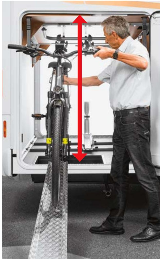
Erweiterung der Beladungshöhe durch einfaches Hochschwenken des innenliegenden Heckbetts mit einer Hand und zusätzliche abgesenkte Bodenmulde (somit Lenkerhöhe Pedelec bis 124 cm möglich)
