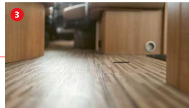
^ „One-Level-“Wohnraumboden – stufenlos und durchgehend vom Fahrerhaus bis in den Heckbereich
