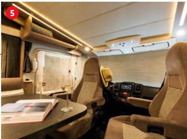
^ Das Hohlwaben-Isolierfrontscheibenplissee mit Vertikalbedienung dient zur Verdunkelung oder zum Sichtschutz. Die Hohlwaben isolieren den Wohnraum gegen Wärme- und Kälteeinfluss über die Frontscheibe.
