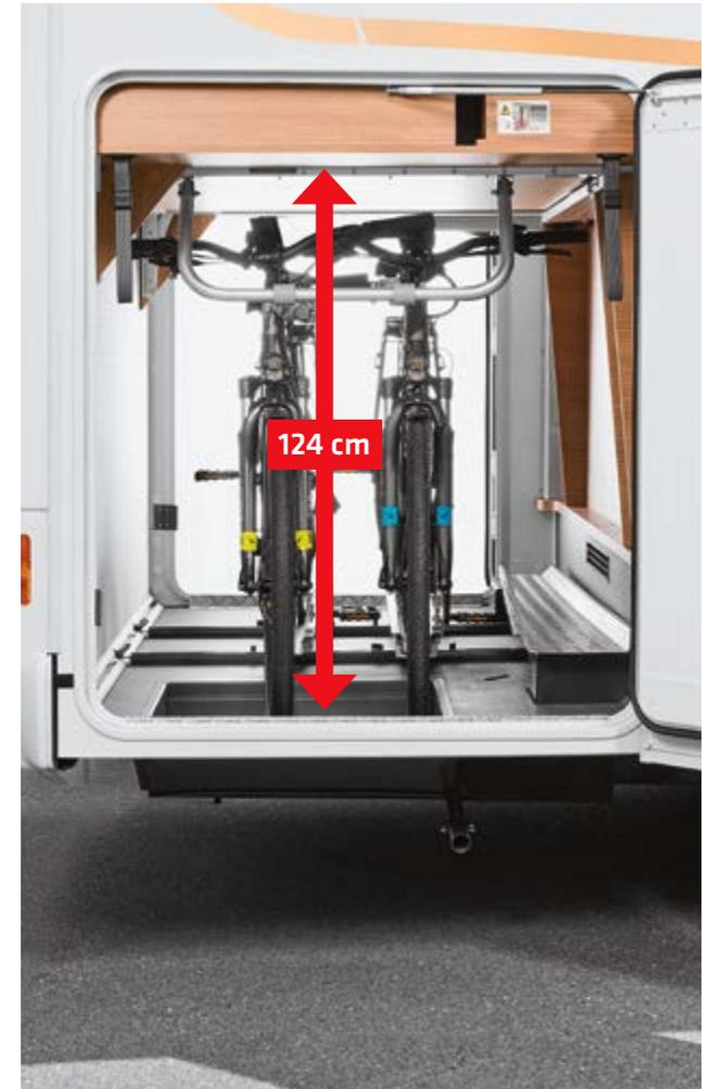
Das Malibu Einschub- und Transport-Fixierungssystem ermöglicht den einfachen Einschub des Pedelecs in die Garage und die sichere Fixierung während der Fahrt mit nur wenigen Handgriffen.
