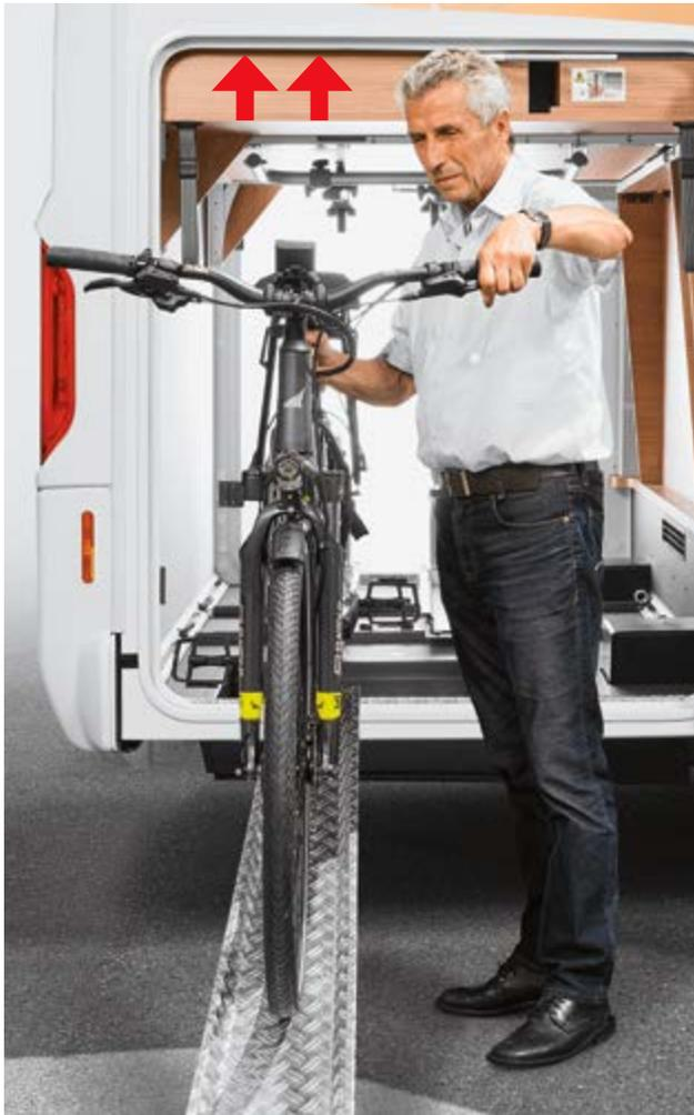
Leichte Beladung eines Pedelecs oder Motorrollers durch einhängbare Auffahrschiene
