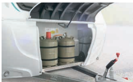
» Gasflaschenkasten für 2x11kg, Boden des Gasflaschenkastens aus verrottungssicherem, stabilem Aluminium-Riffelblech
